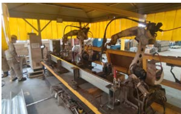
箱式房立柱机械手自动焊接 1
