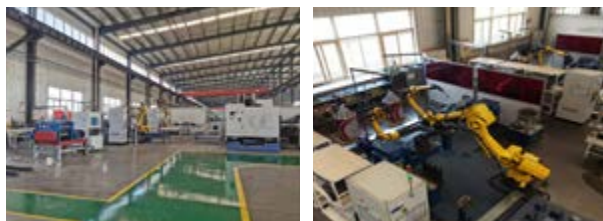
角件焊接工作站
