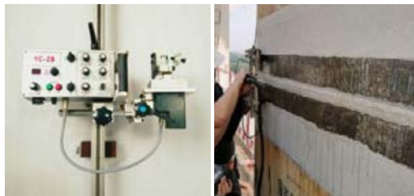
图 12 YC-ZB 轨道摆动焊接小车
