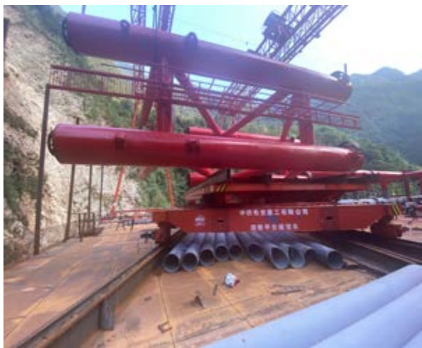
图 13 110 吨旋转平台运梁车
