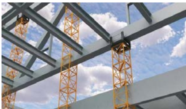
图 8 支架安装模拟
