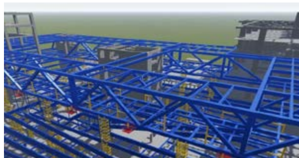
图 16 大跨度钢桁架安装 BIM 模拟技术
