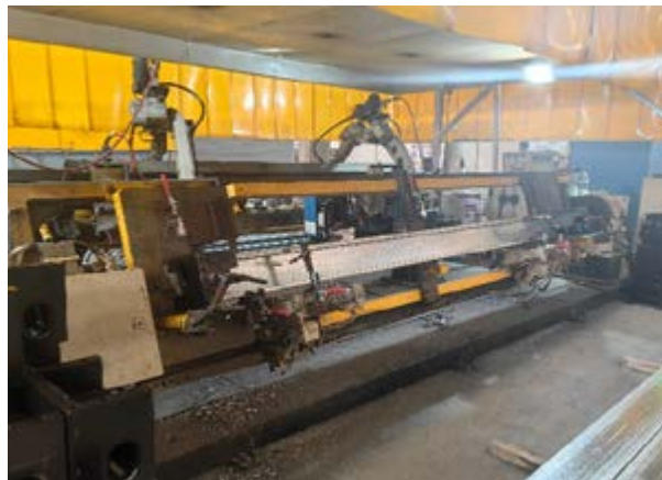
屋面梁机械手自动焊接 2
